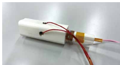
図1. 4年生が3Dプリンターで試作した電離ガスデバイスの写真。
