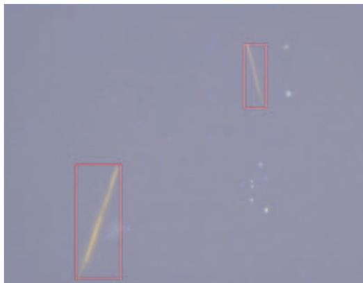
アスベスト検出の例 (赤い枠で囲われた部分が自動的に検出されたアスベストです)
