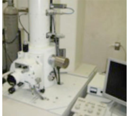
冷陰極フィールドエミッション電子銃とPC制御による操作系を備えた走査電子顕微鏡
